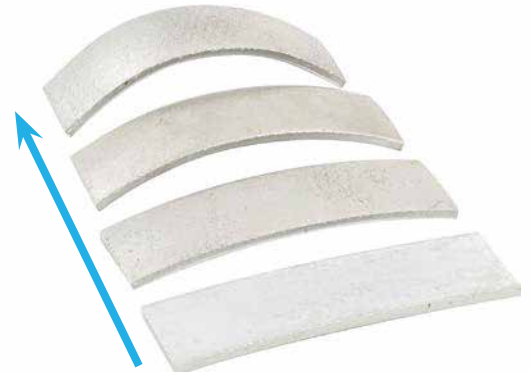
• UNS Verformungseffekt an Aluminium bei fortschreitender Verfestigung der Oberfläche
