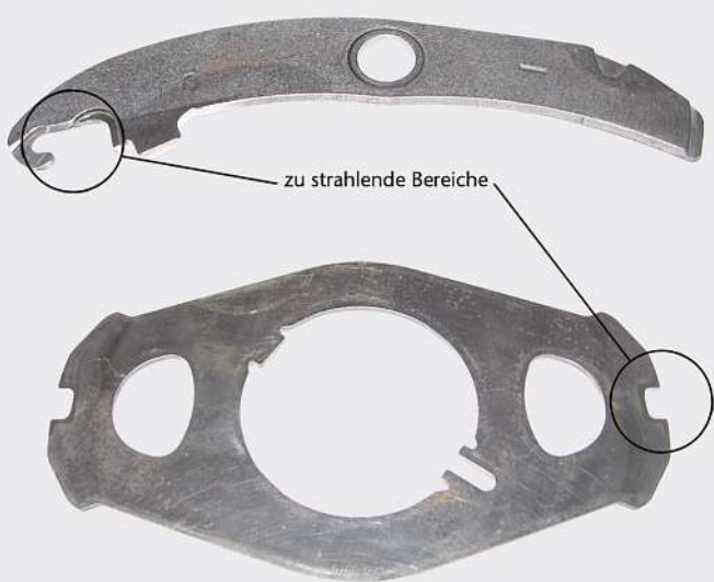
Bild 2: Maschinenteile, bei denen die Randschicht an zyklisch beanspruchten Stellen verfestigt wird. Sie kommen in Textilmaschinen zur Anwendung.
