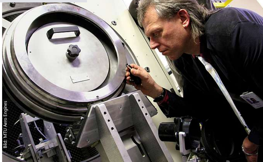
Visuelle Oberflächenprüfung an einem Bauteil-Dummy im Rahmen einer Verfahrenseinführung. Das Ultraschall-Kugelstrahlen erzeugt glattere Oberflächen als konventionelle Shot-Peening-Verfahren.
